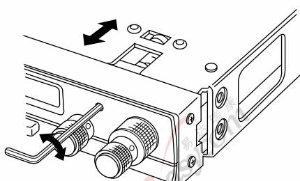
使用3/32英寸长的销将电台连接到MB-53
